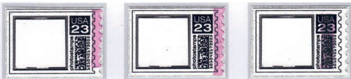
Fig. 1: Der er anvendt tre forskellige typer tagging i forsøgsperioden. Til venstre: Højde 29 mm, i midten: Højde 35 mm, til højre: Dækker 2D koden.
